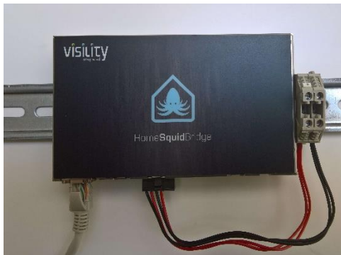
Visility HSB tilsluttet klemrækker i tavle.
